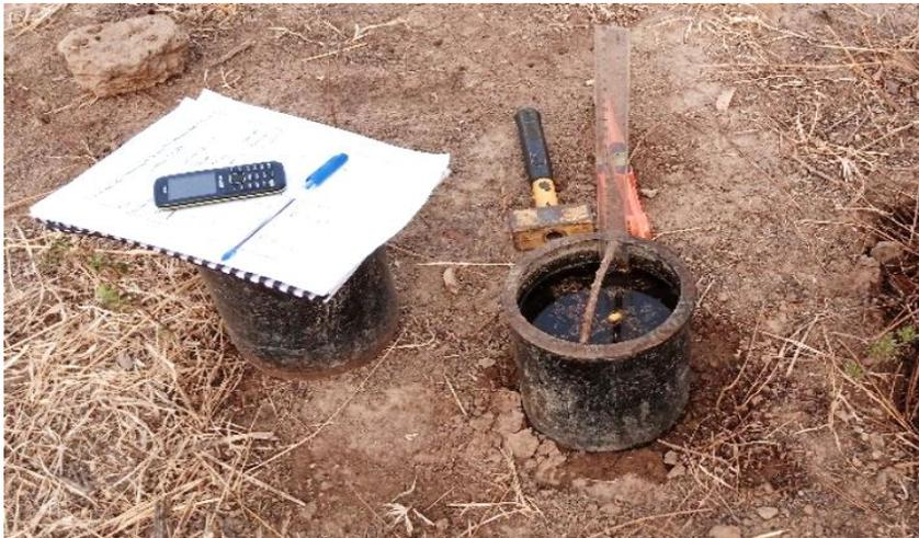
Infiltromètre (diamètre 17 cm, hauteur 20 cm)
