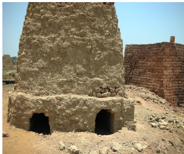
Figure 10 : Four à charbon de bois en milieu semi-aride: Ouest du Burkina Faso. Source : Martin NGANJE.
