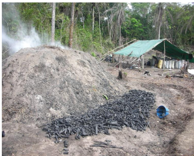
Figure 9 : . Four à charbon de bois en milieu forestier humide: Sud ouest de la Côte d'Ivoire. Source : Martin NGANJE.
